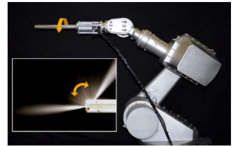
Abb. 3: Aufbau eines automatisierten Reinigungssystems, bei welchem die Werkstoffauswahl für die verbauten Bewegungselemente aufgrund von Voruntersuchungen nach dem CSM-Bewertungsverfahren erfolgte.
